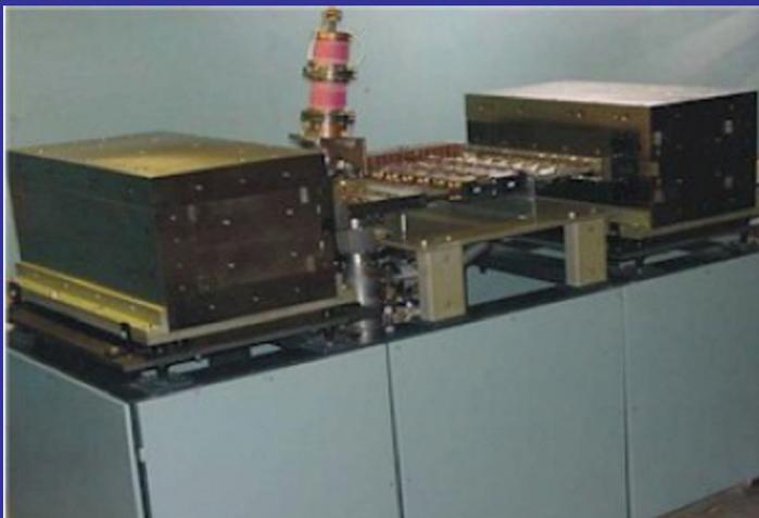
Импульсный резрезной микротрон RTM-70
