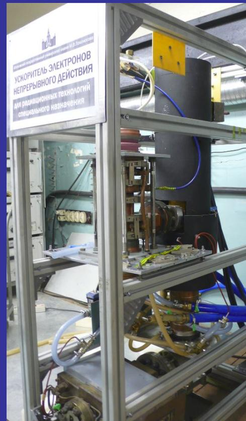
Линейный ускоритель электронов непрерывного действия для радиационных технологий и испытаний материалов на радиационную стойкость. Энергия 1 МэВ, средний ток пучка  $\sim 10$  мкА – 25 мА.
